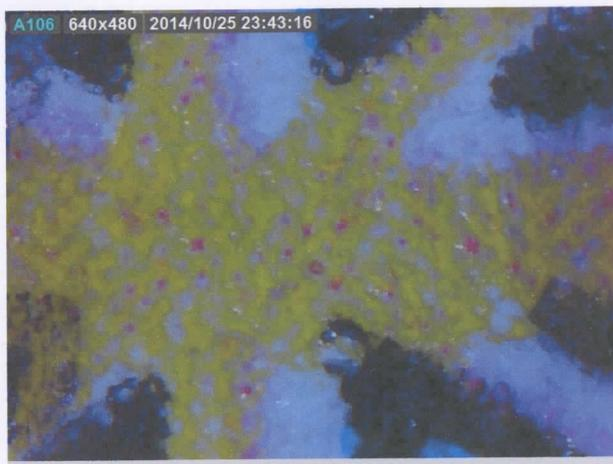
Nel dettaglio le tracce di magenta lasciate dal solvente utilizzato per lo scolorimento
